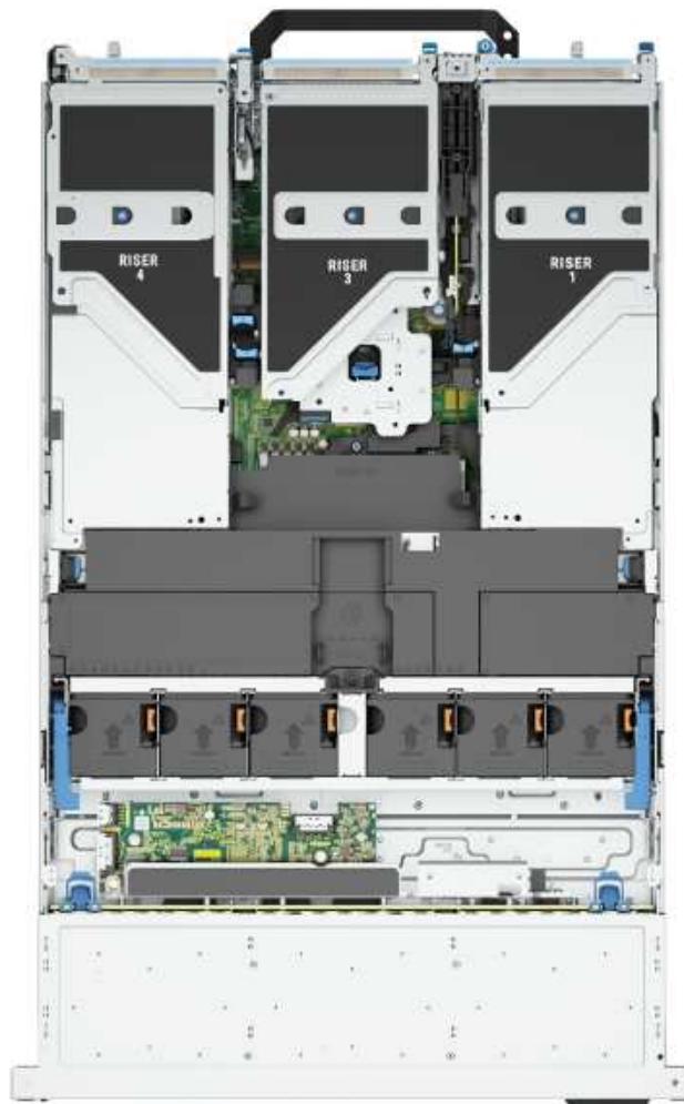
Figura 15. Visão interna do sistema com risers de comprimento completo e defletor da GPU
