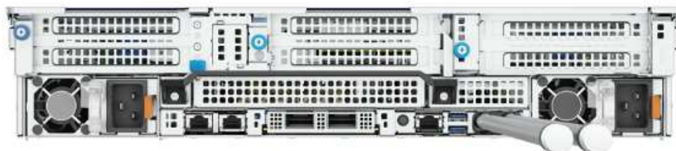
Figura 12. Visão posterior do sistema com refrigeração a líquido direta
