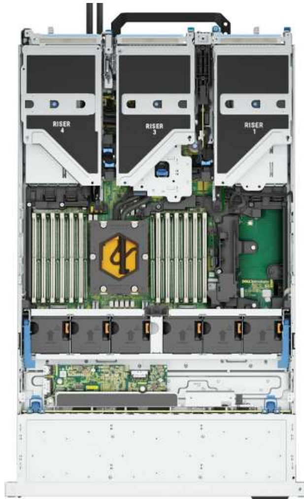
Figura 16. Dentro do sistema com módulo de refrigeração a líquido do processador
