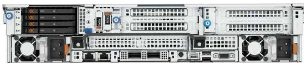
Figura 13. Visão posterior do sistema com módulo de 4 unidades traseiras EDSFF E3.S
